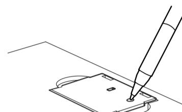
Le voyant lumineux rouge du bouton de configuration clignote brièvement puis s'allume pendant environ cinq secondes pour indiquer qu'il est prêt à recevoir le signal de configuration. Pendant 5 secondes, appuyez brièvement sur le bouton Test du Détecteur 1 pour interconnecter les deux détecteurs sans fil.
