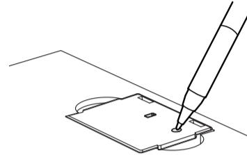
Het rode ledlampje naast de inleerknop zal kort knipperen en vervolgens ongeveer vijf seconden branden om aan te geven dat de melder klaar is om het inleersignaal te ontvangen. U hebt dan 5 seconden de tijd om kort op de testknop op Melder 1 te drukken en beide melders draadloos door te koppelen.
