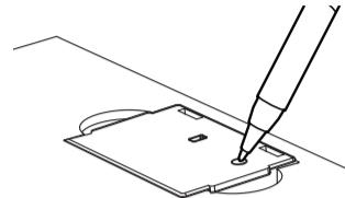
Die rote LED neben der Einlerntaste blinkt kurz auf und leuchtet dann etwa 5 Sekunden, um anzudeuten, dass der Melder bereit ist, das Einlernsignal eines anderen Melders zu empfangen. In den nächsten 5 Sekunden müssen Sie die Testtaste am Melder 1 kurz drücken, um die Vernetzung der beiden Melder herzustellen.
